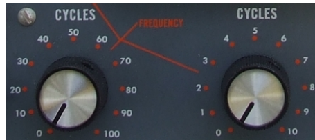
12. ábra a generátor frekvenciakiválasztó kezelőszervei (a szorzó nélkül)
