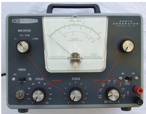
10. ábra áthidalt T-tagos szinuszos, elektroncsöves generátor előlapi fényképe
